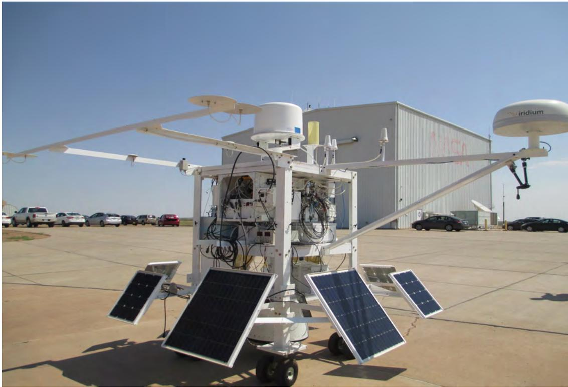
**Figura 24: Imagen de la góndola de la NASA preparada con PIXQUI montado en su interior.**
