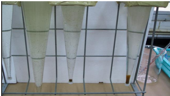
Figura 3.7 Conos Imhoff para determinación de sólidos sedimentables.
