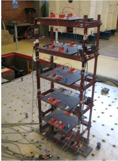
Figura 1.1. Modelo de acero analizado en el laboratorio de la mesa vibradora del Instituto de Ingeniería de la UNAM
