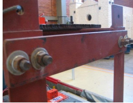
b) Colocación de soleras en el modelo
