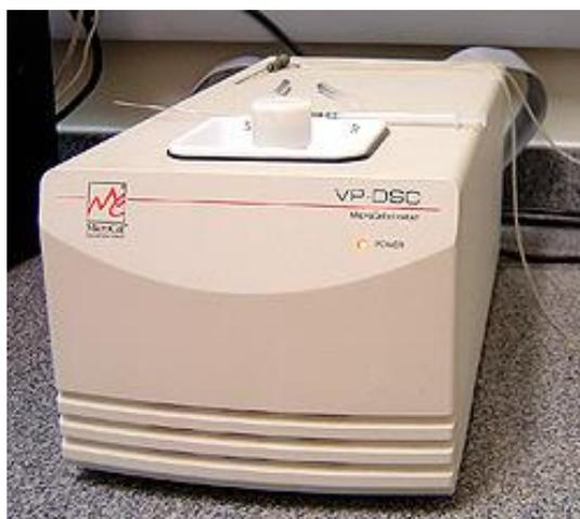
Fig. 1.11. Calorímetro Diferencial de Barrido, VP-DSC
