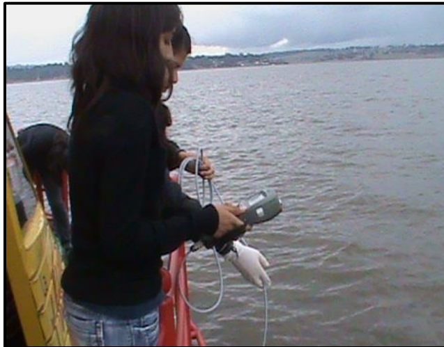
Figura 3.8 Determinación de parámetros in situ, utilizando el medidor multiparamétrico.
