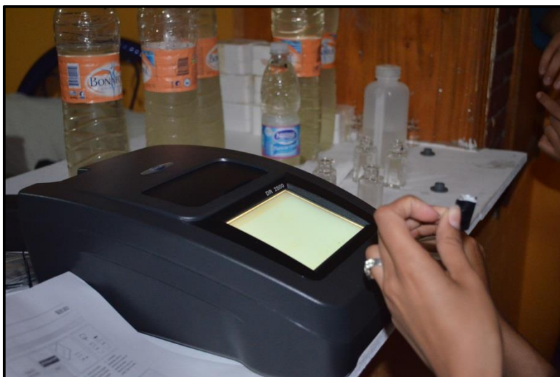
Figura 3.9 Determinación de parámetros químicos, utilizando el espectrofotómetro.
