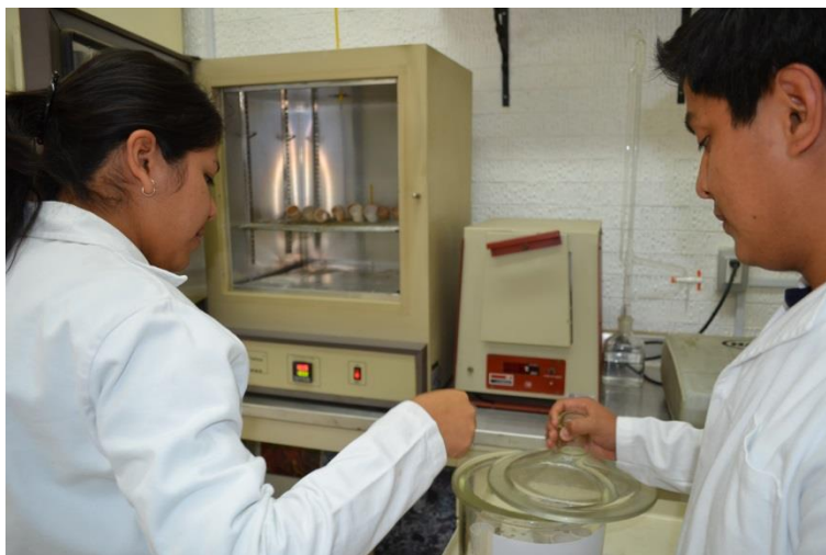
Figura B.1 Después de la filtración, se colocan los crisoles con filtro Gooch en el horno a 105 °C.
