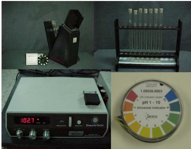
Figura 2.5 Colorímetro (esquina superior izquierda), tubos Nessler (esquina superior derecha), espectrofotómetro (esquina inferior izquierda) y papel pH (esquina inferior derecha).
