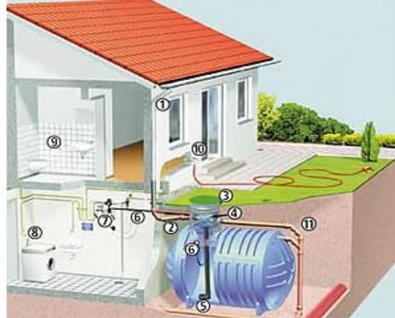
FIGURA 46. Sistema de re-uso de agua pluvial.
