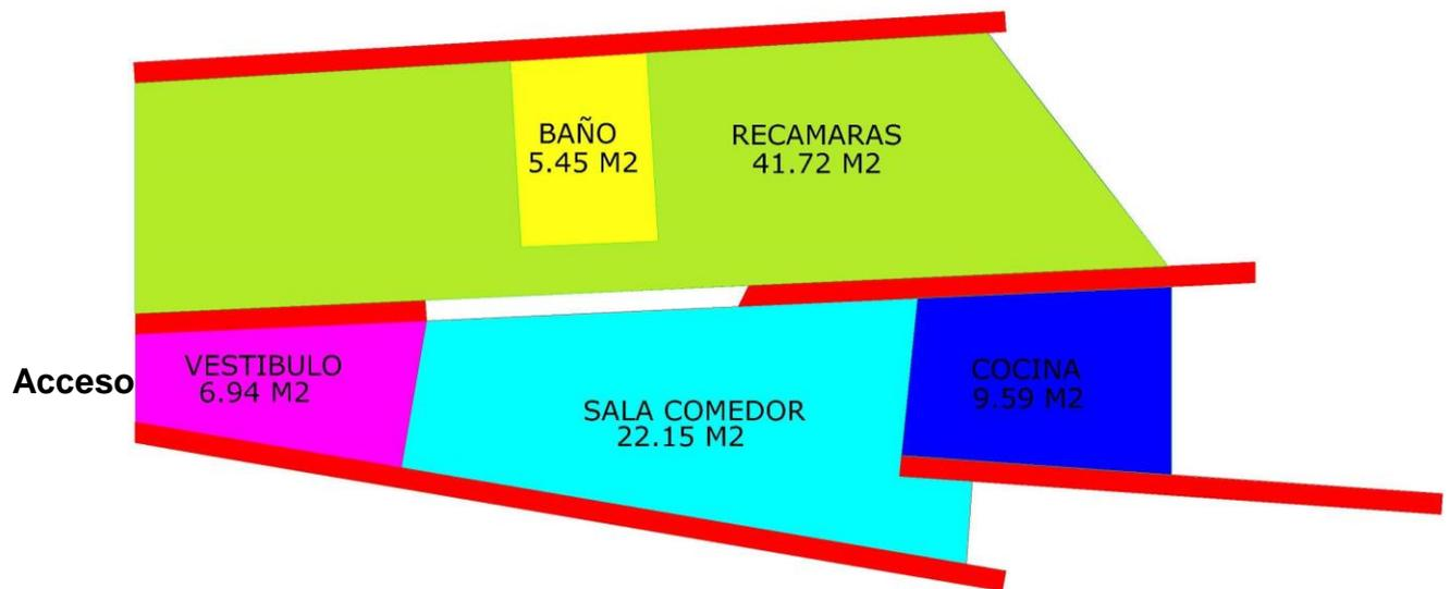
FIGURA 76. Zonificación en planta de una vivienda tipo, resaltando en rojo los muros portantes.
