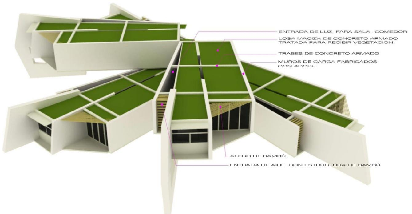
FIGURA 90. Esquema isométrico del grupo de viviendas.
