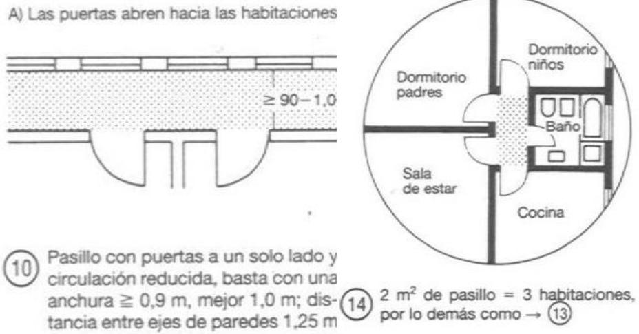
FIGURA 49. En esta figura se presentan las circulaciones principales y el ancho mínimo de los pasillos. . (Arte de proyectar en arquitectura - GG 14 ed Neufert 1995)
