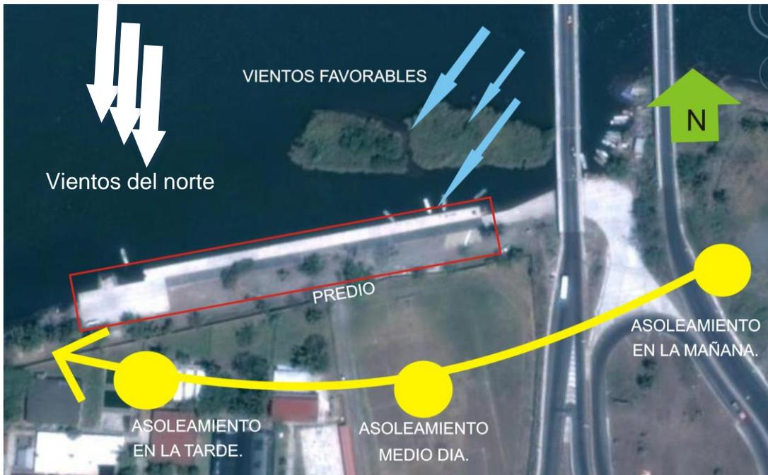
FIGURA 31. Esquema de dirección de vientos favorables y movimiento solar sobre el predio.
