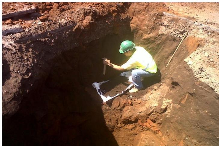
Imagen 6.7.- Obtención de las muestras alteradas del sondeo dos.
