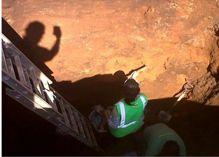
Imagen 6.3.- Obtención de muestras alteradas.
