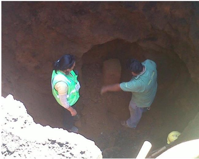
Figura 4.5.- obtención de una muestra inalterada de la pared de un corte.
