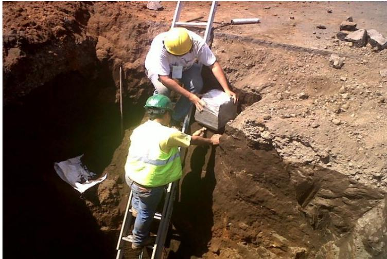
Imagen 6.8.- Obtención de la muestra inalterada del sondeo dos.
