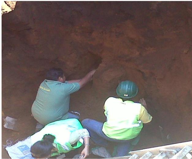
Figura 4.4.- Obtención de muestra inalterada.
