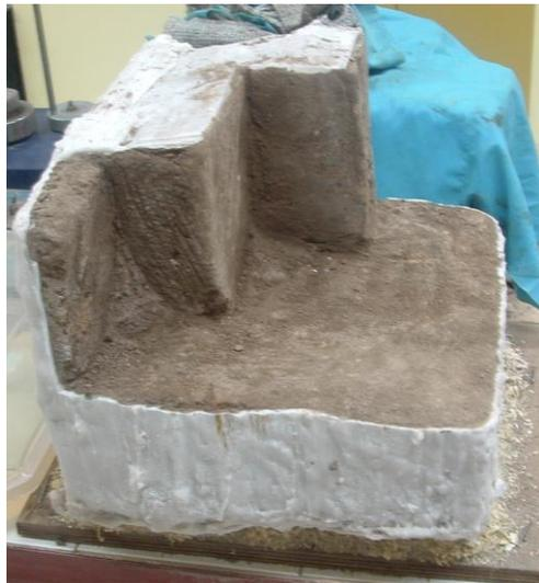
Figura 3.17.- Obtención de probetas.
