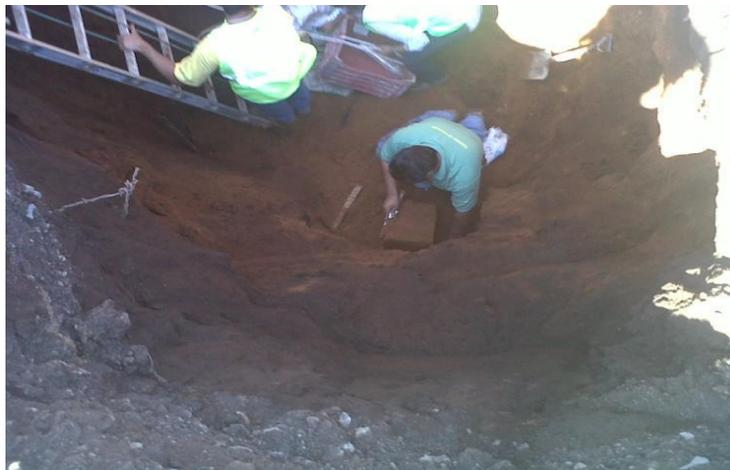
Imagen 6.4.- Obtención de muestras inalteradas.
