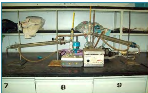
FOTOS 28 Y 29. DETERMINACIÓN DE NITRÓGENO AMONICAL POR LA TÉCNICA DE KJENDAHL
