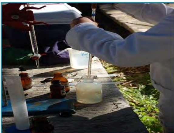
FOTOS 25 Y 26. DETERMINACIÓN DE OXÍGENO DISUELTO IN SITU POR LA TÉCNICA DE WINKLER CON LA MODIFICACIÓN DE AZIDA DE SODIO Y SIEMBRA DE COLIFORMES TOTALES POR LA TÉCNICA DE TUBOS MÚLTIPLES
