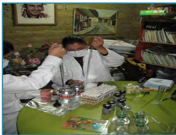
FOTOS 25 Y 26. DETERMINACIÓN DE OXÍGENO DISUELTO IN SITU POR LA TÉCNICA DE WINKLER CON LA MODIFICACIÓN DE AZIDA DE SODIO Y SIEMBRA DE COLIFORMES TOTALES POR LA TÉCNICA DE TUBOS MÚLTIPLES
