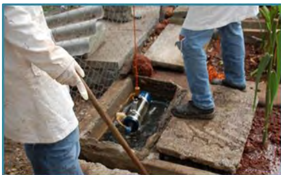
FOTOS 23 Y 24. TOMA DE MUESTRAS EN LOS DEPÓSITOS COLECTORES DE LAS CANALETAS CON LA AYUDA DE BOTELLAS VAN DORN CON LA FINALIDAD DE CONSEGUIR MUESTRAS HOMOGÉNEAS Y REPRESENTATIVAS DE AGUA RESIDUAL
