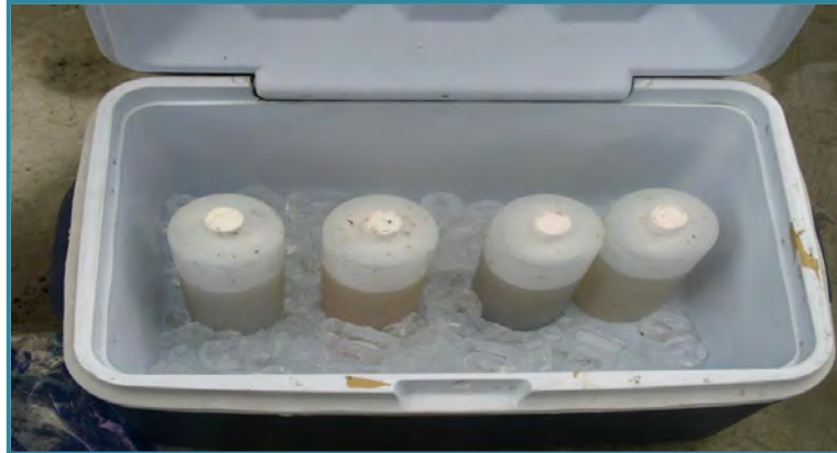
FOTO 27. TRASLADO DE MUESTRAS AL LABORATORIO EN HIELERAS PARA REDUCIR LA TEMPERATURA A APROXIMADAMENTE 4° C
