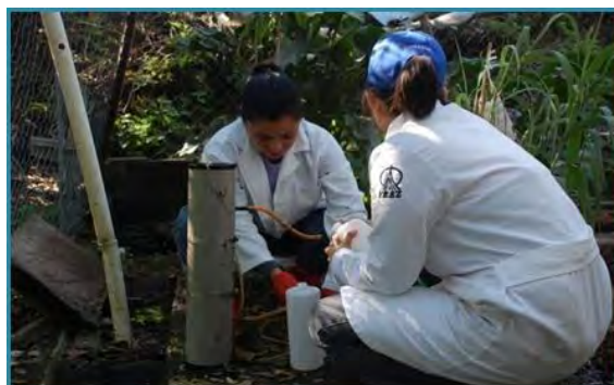
FOTOS 23 Y 24. TOMA DE MUESTRAS EN LOS DEPÓSITOS COLECTORES DE LAS CANALETAS CON LA AYUDA DE BOTELLAS VAN DORN CON LA FINALIDAD DE CONSEGUIR MUESTRAS HOMOGÉNEAS Y REPRESENTATIVAS DE AGUA RESIDUAL
