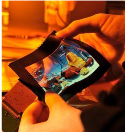
Figura 3.12. Prototipo de pantalla OLED flexible.
