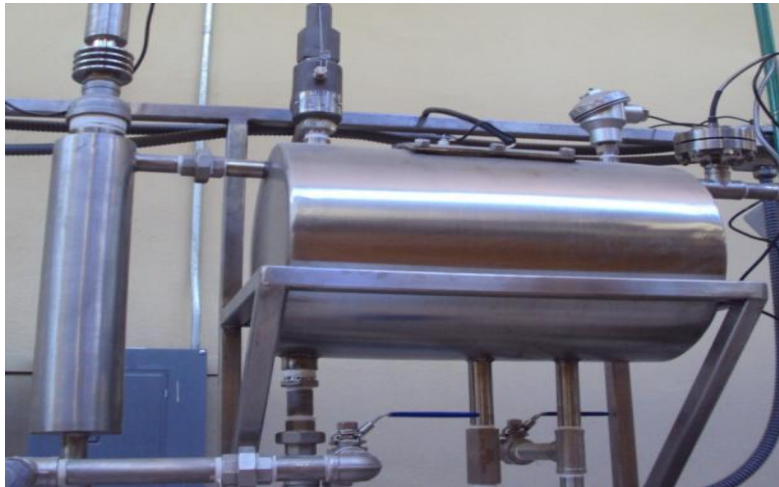
Figura 3 [Imagen de la desaladora electrostática operando en la Facultad de Química de la UNAM]
