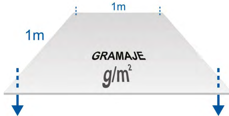
Imagen 6. El gramaje del papel esta dado por el peso y el área.
