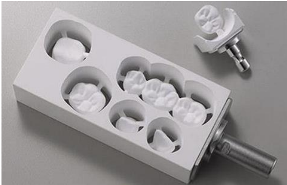
Fig.5 Núcleos y restauraciones monolíticas de zirconio fresadas por sistema CAD-CAM antes de la sinterización final.
