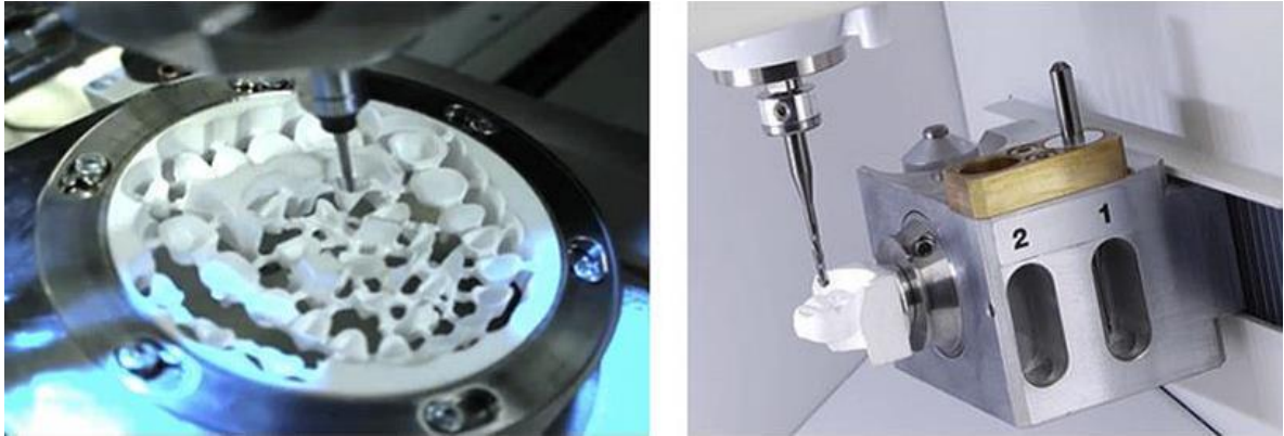
Fig.3 Proceso de fresado de restauraciones por medio del sistema CAD-CAM.
