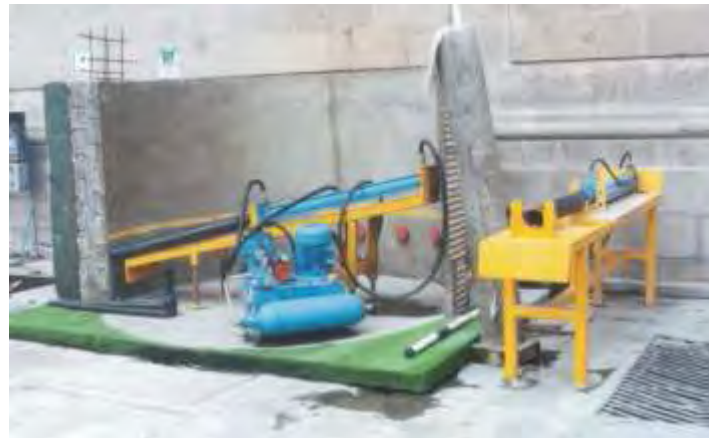
Fig. 53 Subexcavación manual y equipo empleado
