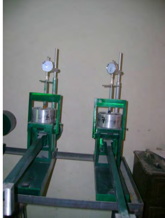
PRUEBA DE CONSOLIDACIÓN
