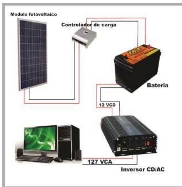
Figura 3.24 Conexión de un sistema solar fotovoltaico básico.
