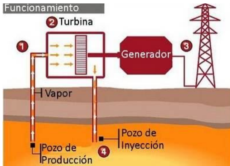
Figura 1.3 proceso para generar energía eléctrica en una planta geotérmica. [Central geotérmica]. Recuperado de http://antonioboveda.blogspot.mx/2011/03/terminos-tema-8-naturaleza-y-recursos.html .
