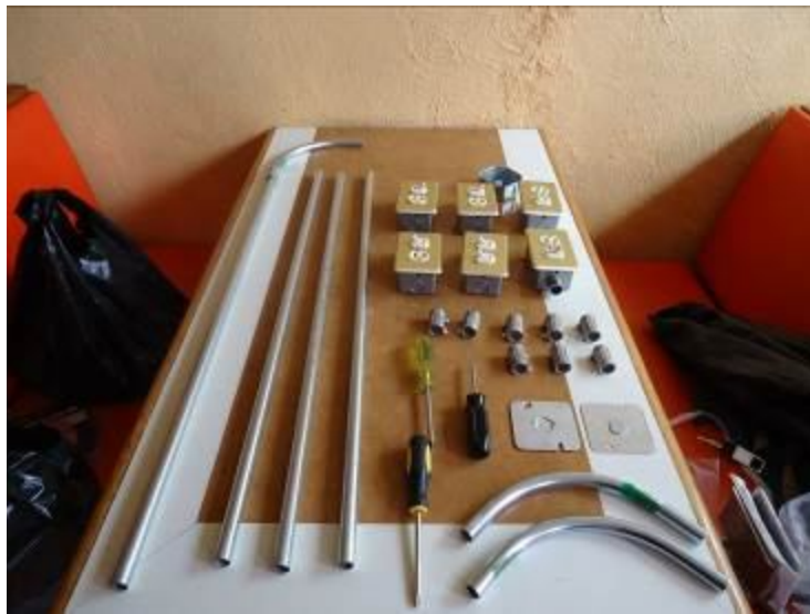
Figura 3.20 Materiales para instalación eléctrica.
