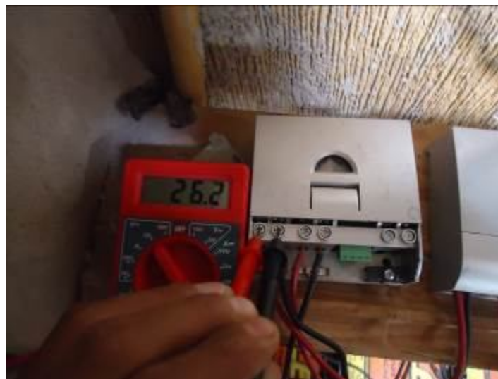
Figura 3.31 Voltaje del controlador de carga.
