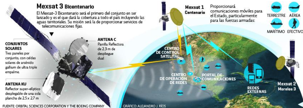
Gráfico 22. Cómo funciona el nuevo sistema de satélites MEXSAT. (Ríos, 2011).
