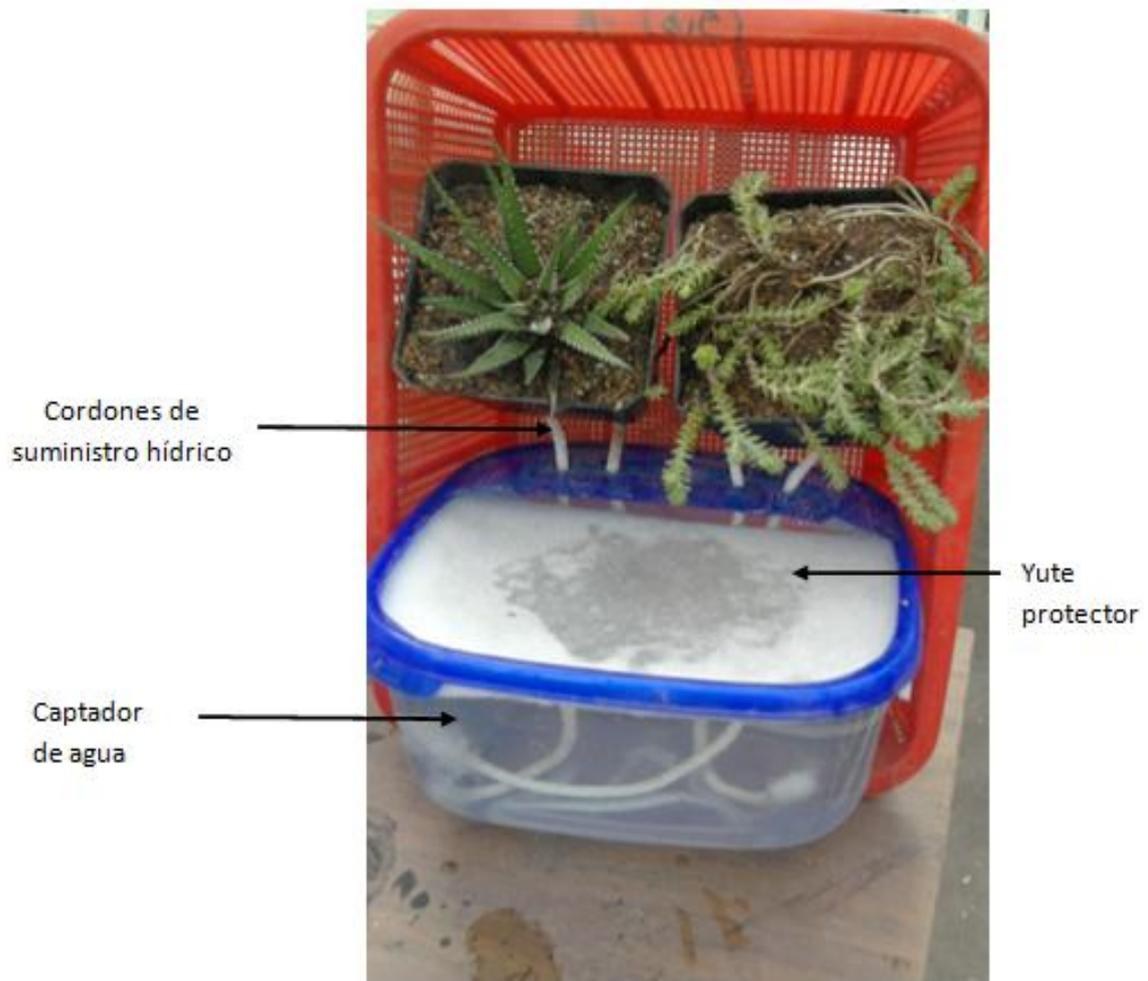
Figura 4. Modulo armado
