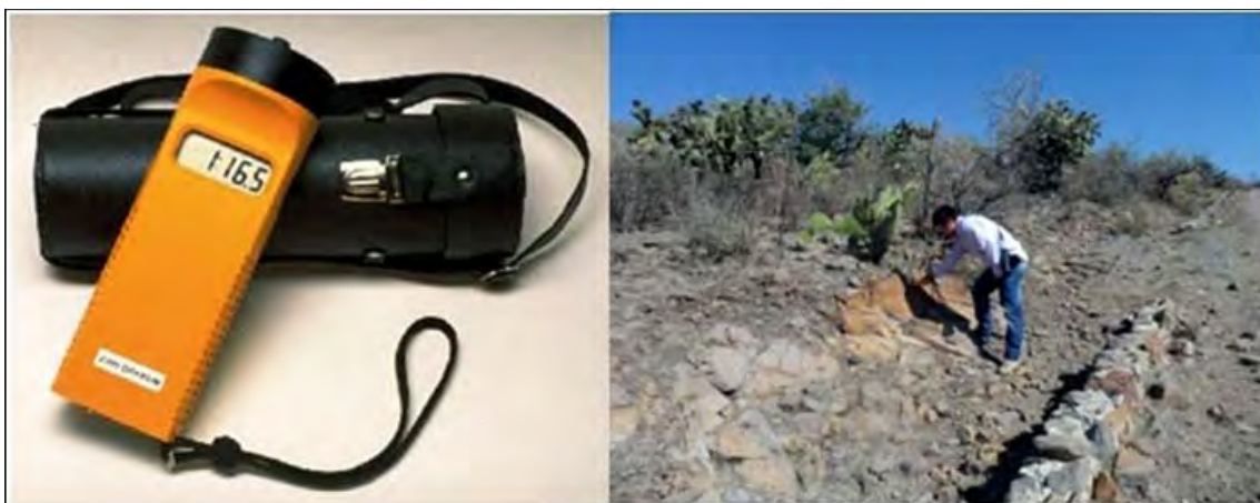
FIGURA 24.- Fotografías del equipo utilizado para las mediciones in situ de susceptibilidad magnética. Del lado izquierdo es el suceptibilímetro KT-9 y del lado derecho muestra el realizado in situ .
