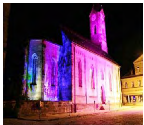
FIGURA 1.1 ILUMINACIÓN DE SUPERFICIES VERTICALES CON TECNOLOGÍA RGB .PARA EXTERIORES CON LEDS DE ALTA POTENCIA DE 1W. FOTO EXPERTO EN LUMINARIOS © ILUMINET. OBTENIDA EL 7 DE JULIO, 2013 DE: http://www.iluminet.com.mx/wp-content/uploads/2008/10/leds-torres
