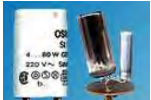
FIGURA 1-7 ARRANCADOR. GARCÍA ÁLVAREZ, JOSÉ ANTONIO E .2004-2013. OBTENIDA EL 5 DE JULIO, 2013 DE: http://www.asifunciona.com/electrotecnia/af_fluorescentes/af_fluorescentes_5.html
