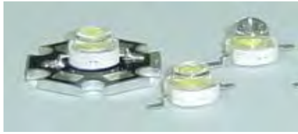
FIGURA 2.7 LED DE ALTA POTENCIA DE 1W CON DISIPADOR Y SIN DISIPADOR. Z-LIGHT. Technical Datasheet Rev. B (2006.5). OBTENIDA EL 15 DE JULIO, 2013 DE: http://www.casadelled.com.ar/Xpower%201%20%20data%20sheet(English)%202.pdf
