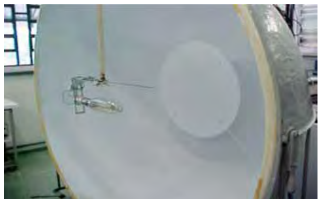
FIGURA 2.8 ESFERA INTEGRADORA SISTEMAS DE ILUMINACIÓN. GIL OLIVERA JOSÉ., 2010. CAPÍTULO VII. APLICACIONES DE LED'S Y FOTOMETRÍA.
