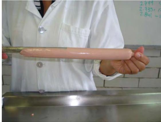
Figura 2.5 Embutido de la emulsión cárnica.
