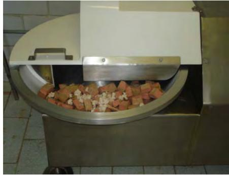
Figura 2.3 Mezclado de la materia prima cárnica.
