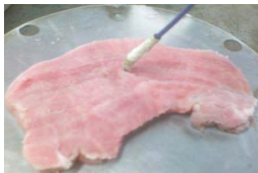
Figura 22. Posición del termopar en el corte de carne porcina.
