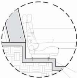
DETALLE DE-1 FIJACION DE BUTACAS A HERRERIA
