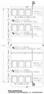
DETALLE -D1 FIJACION DE BUTACAS EN GRADIERIA GENERAL Y FORRAS ARQUITECTONICAS
