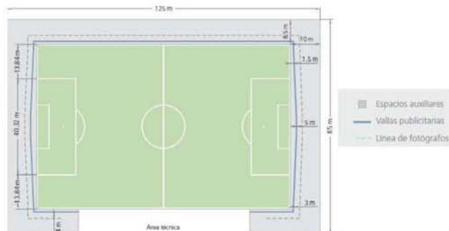
IMAGEN N° 28: Enmarcación del campo deportivo en color verde y Franja de advertencia en color gris
