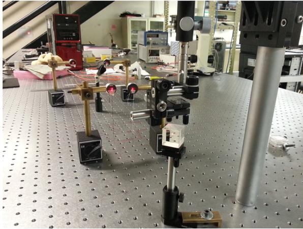
Figura 4.3: Alineación de los pinholes con el detector
