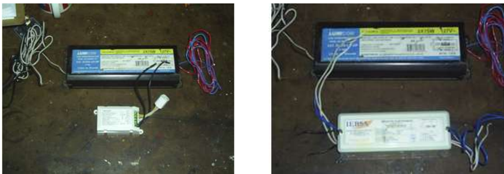
Figura 2.10 Diferencia de tamaño de un balastro electromagnético a un electrónico
