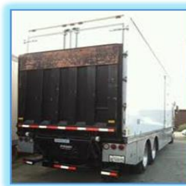
Rampa tipo compuerta
