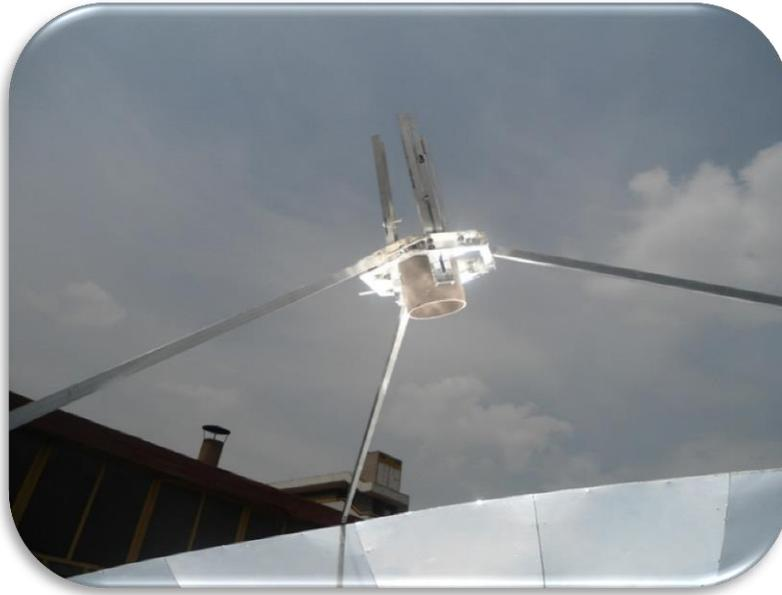
*Imagen 3.3 Prueba inicial con receptor cilíndrico*
