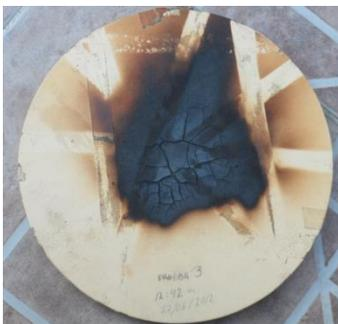
De la tercera prueba no se tienen fotografías de la mancha solar durante la prueba, por lo que sólo se cuenta con la imagen de la madera después de ser expuesta a la radiación concentrada del dispositivo.
