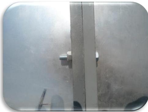
Imagen 2.8. Unión de los segmentos del concentrador
