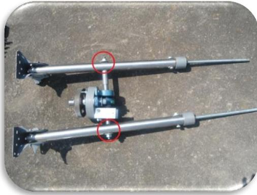
Imagen 2.12. Unión de barras con el sistema de giro
