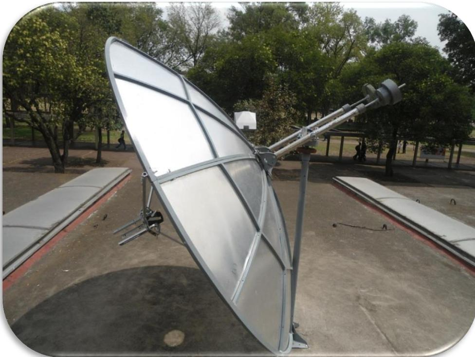
*Imagen 2.20. Concentrador Solar totalmente instalado.*
