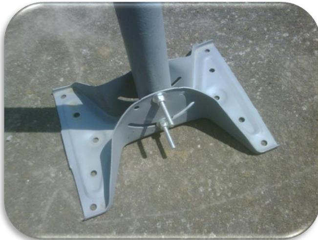
*Imagen 2.3. Base del concentrador antes de ser fijada*
