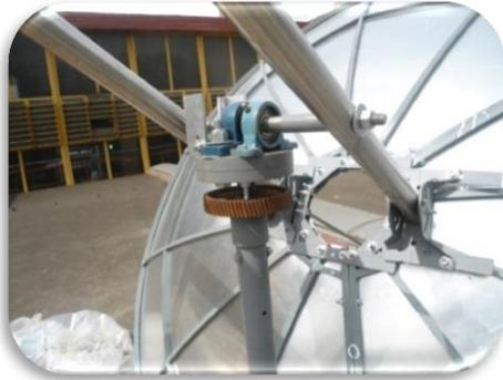
*Imagen 2.15. Sistema completo insertado a la base soporte*
