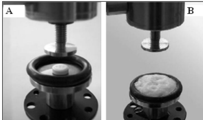
Figura 31. Figura de ElectroForce ® 3100. A) Inicio de la aplicación de la fuerza. B) termino de la etapa de desintegración.
