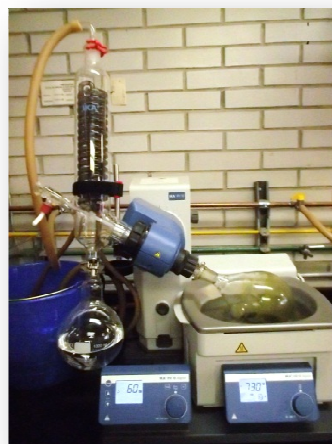
Figura 2. Destilación del extracto metanólico crudo en el rotavapor.
