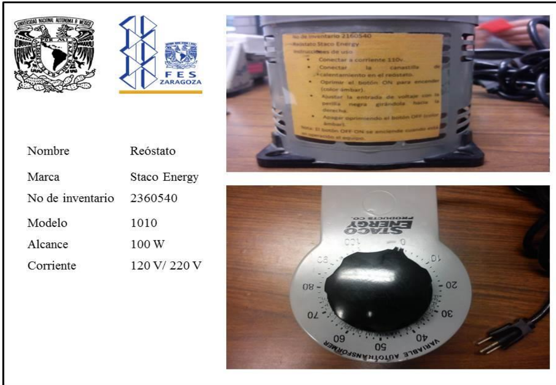
Figura 38.- Reóstato Staco Energy.
