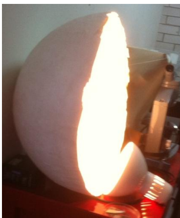
Figura 4.4. Bóveda utilizada como reflector difuso en el cuarto oscuro.
