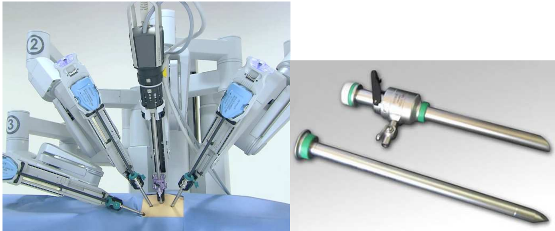
Figura 1.4.1: Robot Cirujano Da Vinci(izq.) y un trocar típico(der.)[1].
