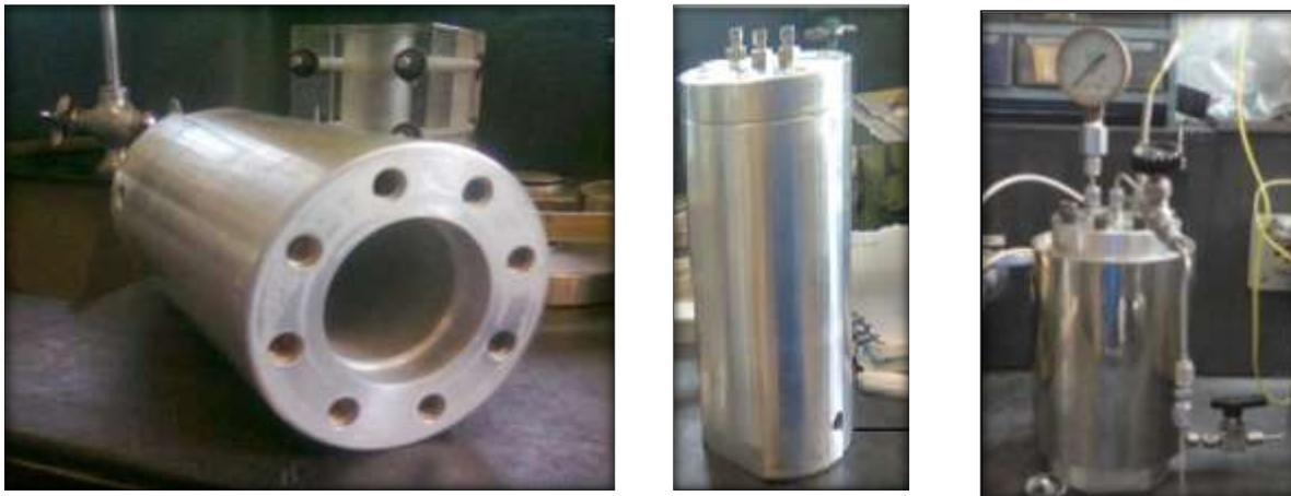
*Figura A.3.- Generador de vapor.*
