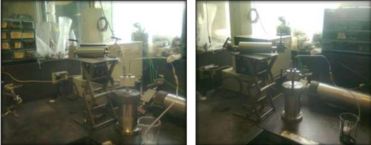
*Figura A.9.- Proceso de saturación de aceite de las muestras de roca*
