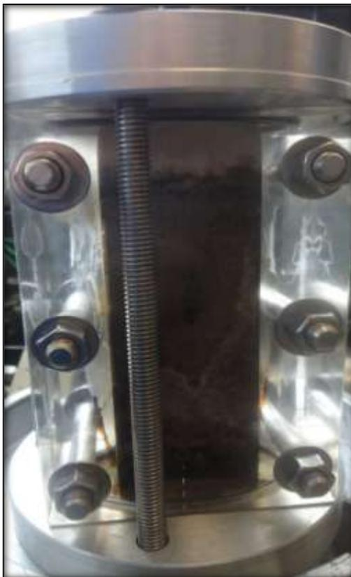
*Figura 4.9.- El sello de las tapas por tornillos limita la toma de imágenes térmicas del proceso.*
