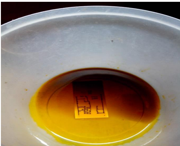
Figura 2.25 y 2.26 Disposición del circuito en tableta fenólica.
