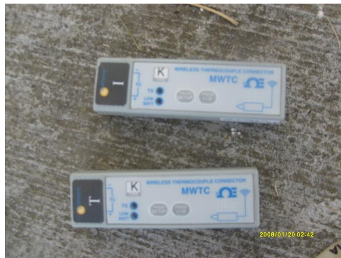
Figura 2.18 Interfaces para la obtención de los parámetros de irradiancia y temperatura.
