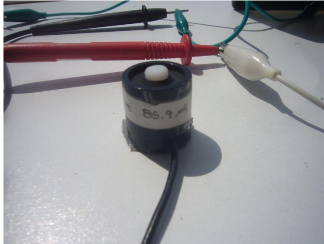
Figura 2.14 Piranómetro usado para medir la radiación global.
