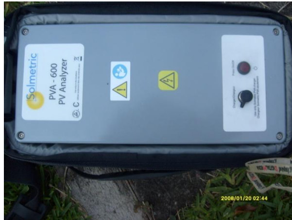
Figura 2.17 Analizador fotovoltaico PVA-600 hecho por Solmetric.
