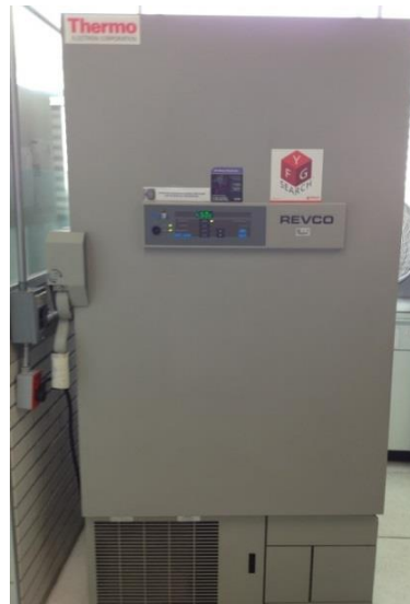
Figura 20. Cámara de congelación REVCO ULTIMA II
