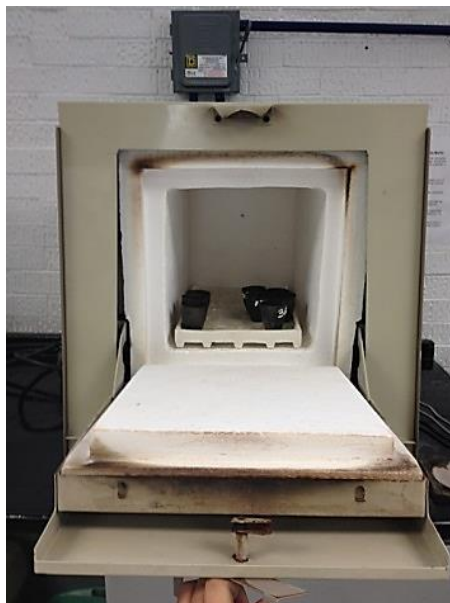
Figura 24. Mufla Linderberg SB para incineración directa
