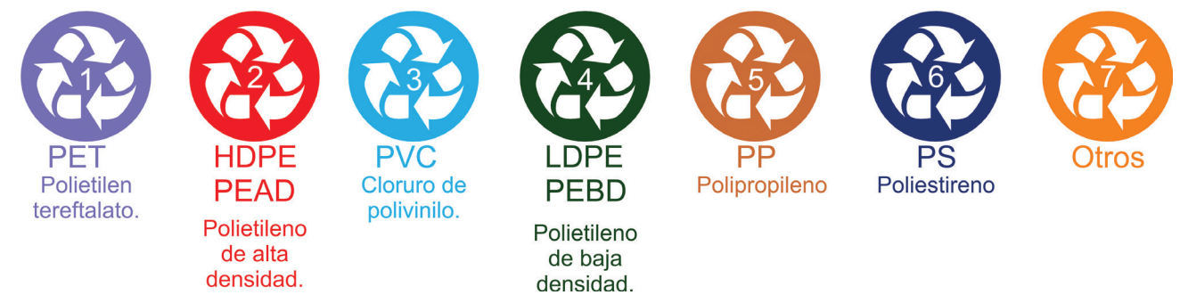
Figura 4. Clasificación de los plásticos, según su polímero. Elaboración propia, tomado de: Ministerio de Ambiente, Vivienda y Desarrollo Territorial de Colombia 24 :
