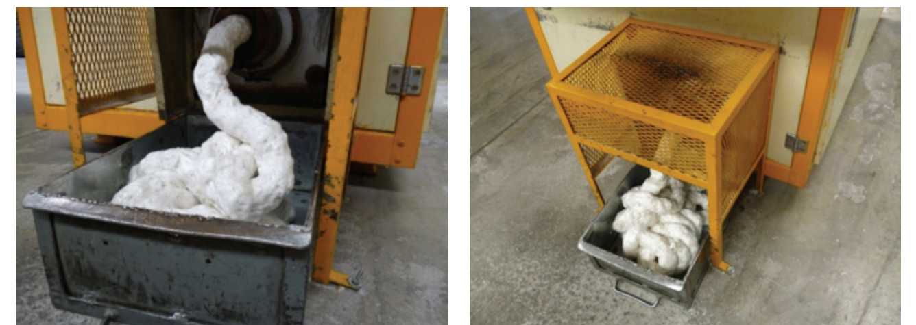
Figura 17. Máquina densificadora (extrae el aire de cada pieza de EPS). "Dart" Atlacomulco, edo de Mex. Fuente: propia. Por medio de un tornillo sinfín el material es movido y sale uniformemente, convertido en una colada continua de PS
