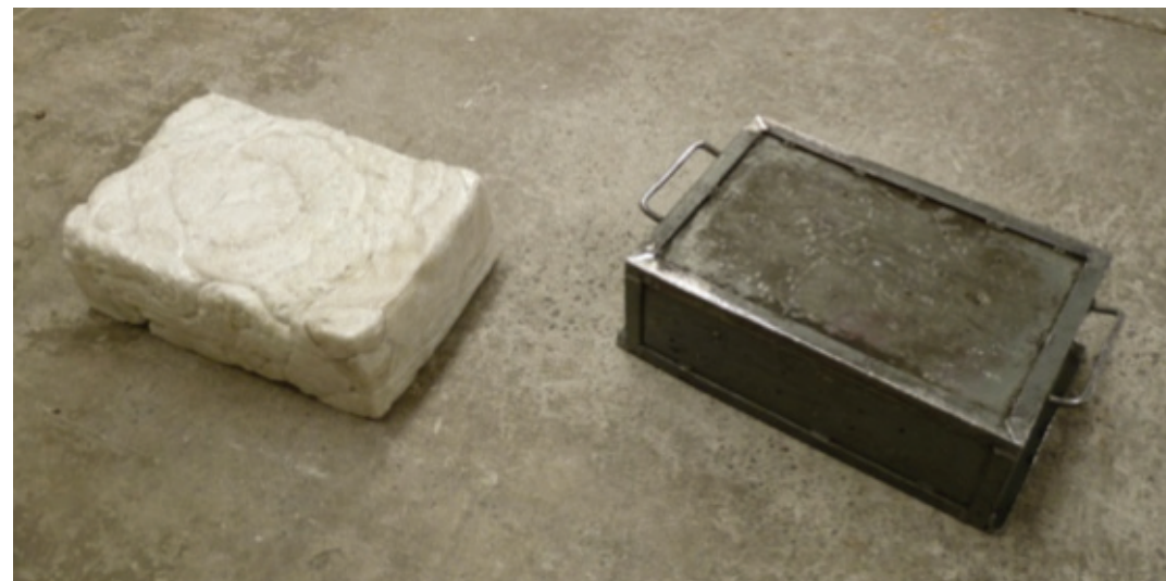
Figura 19. Piezas de 20kg aproximadamente de PS. “Dart” Atlacomulco, edo de Mex. Fuente: propia. Bloques que pueden ser pelletizados según requerimientos del cliente.
