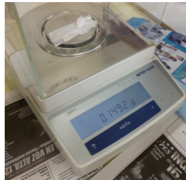
Figura 27. El peso del material es una variable muy importante pues define la cantidad de solvente a usar (% del material vs solvente). Fuente: propia.
