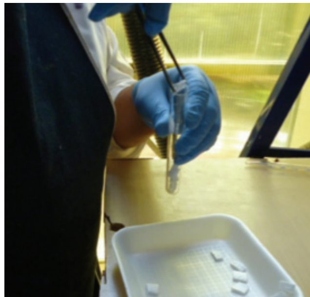
Figura 35. Todo el EPS debe quedar en el fondo del tubo de ensayo para facilitar que se disuelva. Fuente: propia. Para dicho proceso se pueda usar unas pinzas.
