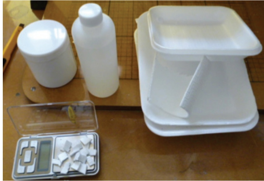
Figura 34. Báscula digital. Fuente: propia. El peso del material es una variable muy importante pues define la cantidad de (ml) de solvente a usar. Porcentaje del material vs solvente.
