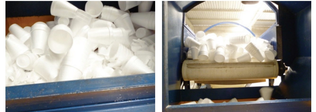
Figura 16. Máquina de redimensionamiento. "Dart", Atlacomulco, edo de Mex. Fuente: propia. Por medio de diversas cuchillas, la máquina transforma los productos de EPS en piezas más pequeñas, para su posterior aprovechamiento.
