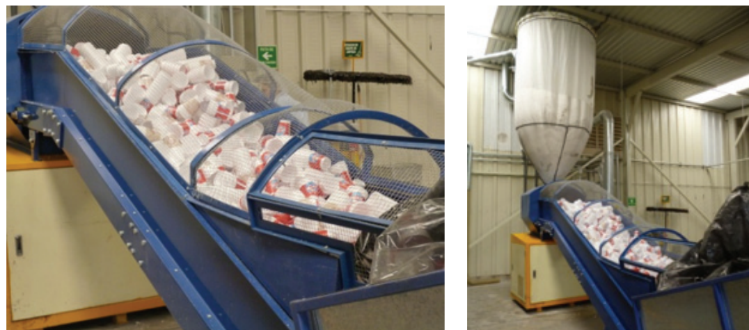
Figura 15. Alimentar la máquina según el material a tratar (discriminación entre productos serigrafiados ó vasos, charolas, etc). "Dart", Atlacomulco, edo de Mex. Fuente: propia.
