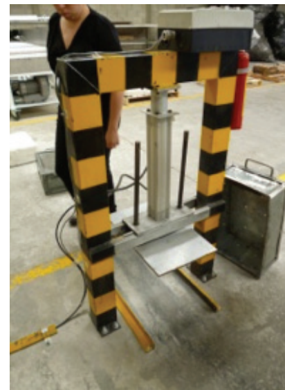
Figura 18. Pistón neumático. “Dart” Atlacomulco, edo de Mex. Fuente: propia. Por medio de un pistón neumático se compacta el material densificado formando los bloques de PS.
