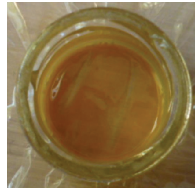
Figura 45. Material “insensible” a estímulos, mezcla de diferentes vasos para bebidas. Fuente: propia. Esta película se obtuvo a partir de la mezcla de diferentes clases de productos fabricados con EPS.
