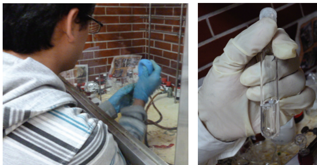
Figura 29. Se debe agregar el disolvente usando guantes y elementos de protección personal en un ambiente dotado de extractores de vapores ya que puede ser un compuesto nocivo para la salud. Fuente: propia.
