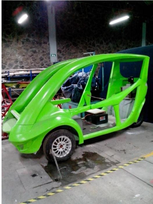
**Imagen 2.6.** Disposición de tres ruedas en dos ejes.
