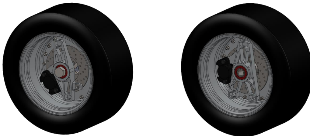
Ensamble de ruedas delantera y trasera del prototipo 2011.
