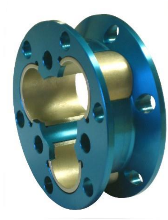
Alojamiento del diferencial para la flecha motriz (tripod).
