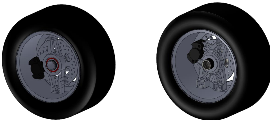
Ensamble de ruedas delantera y trasera del prototipo 2012.
