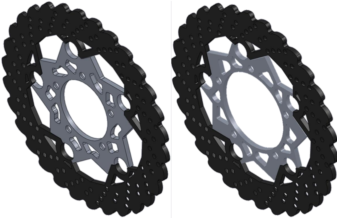
Diseño final de discos de freno delantero y trasero.
