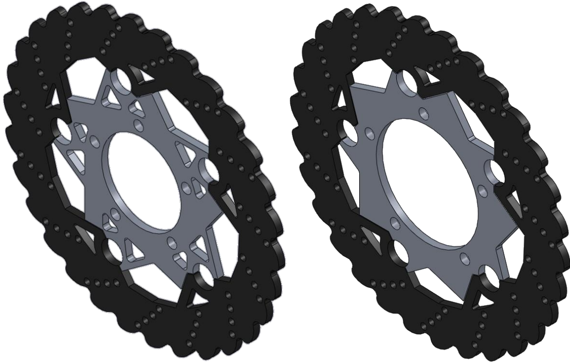
Modelos de discos de freno delantero y trasero (diseños preliminares).
