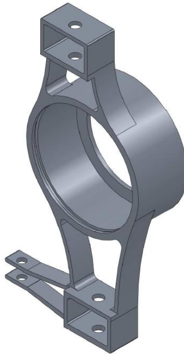
Modelo de mango de suspensión trasero (diseño preliminar).
