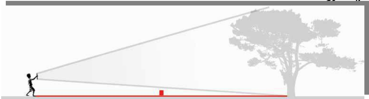
Figura 3. Estimación de la altura del árbol y follaje (modificado de Reforestemos México, A.C).
