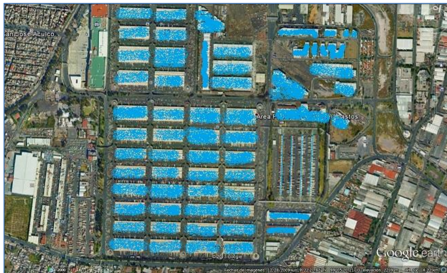
Figura III-12. Superficies de Captación de agua pluvial, marcadas con color azul (Google Earth)
