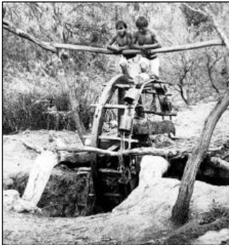
Figura II-9 Bombeo manual (CONAGUA 2009)
