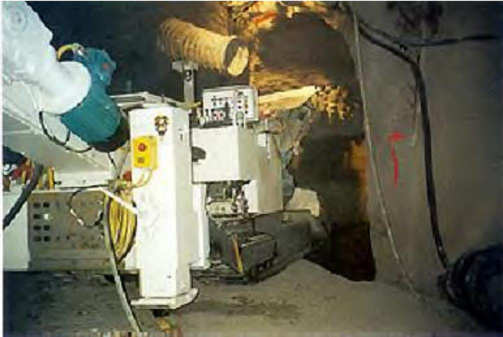
Figura (5) vista de una rasuradora
