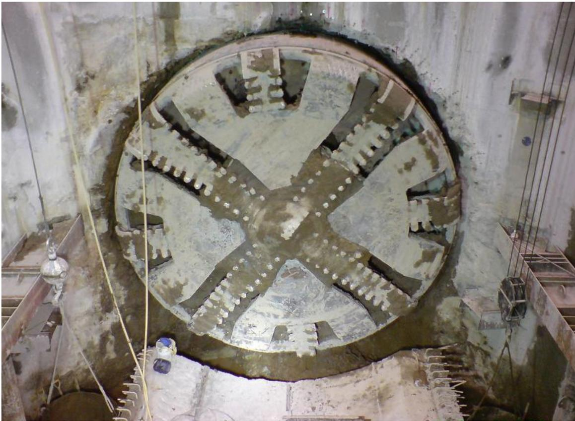
Figura (25) cabeza o elemento excavador
