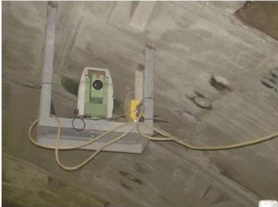
Figura (32) Teodolito Sistema de Guiado en el Túnel
