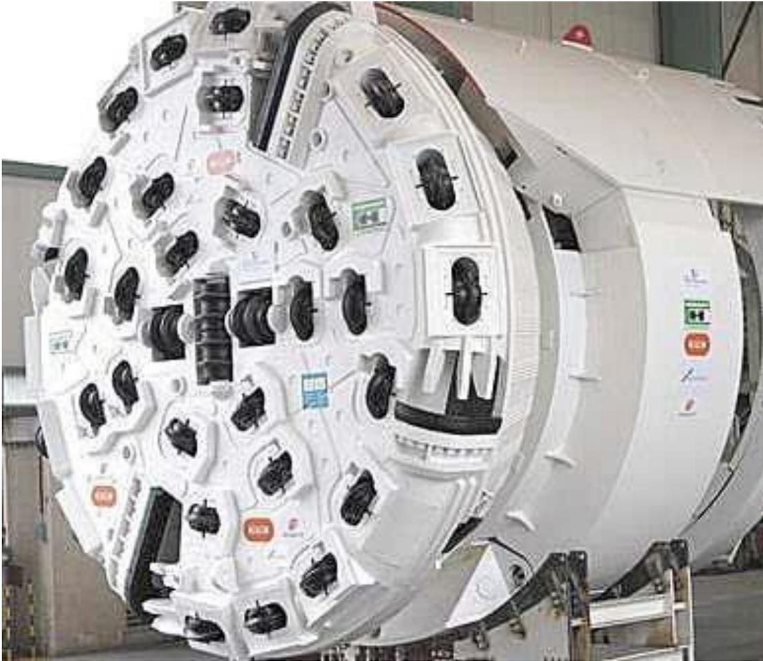
Figura (16) Vista frontal de la rueda de corte que incorpora la cabeza de un topo
