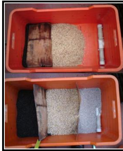
Figura A3-7. Proceso de empacado del sistema HACEV.
