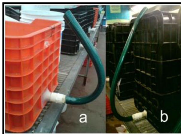
Figura A3-12. (a) Manguera del efluente para los sistemas HAFH y HACEV; (b) Manguera del efluente para el sistema HACEH.
