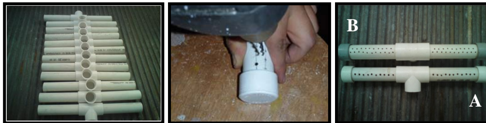
Figura A3-3. Construcción de difusores y colectores. A) patrón 1: difusor de alimentación; B) patrón 2: colector.
