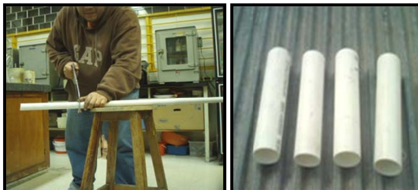
Figura A3-2. Corte de tubo de PVC para la elaboración de los difusores de alimentación y colectores de agua tratada.
