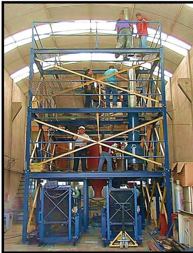
Figura 4. Estructura general y elementos que componen la Planta piloto de Gasificación del Instituto de Ingeniería UNAM (Barrera, 2008)
