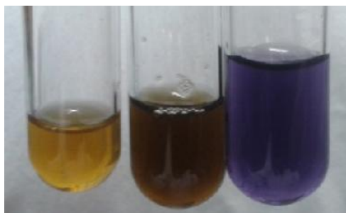
Figura 15. Prueba de FeCl_3 (Fenoles totales). Tubos de izquierda a derecha: extracto de pápalo, extracto de pápalo + reactivo de FeCl_3 (prueba positiva), solución de fenol al 5% + reactivo de FeCl_3 (testigo).
