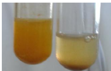
Figura 16. Prueba de Dragendorff (Alcaloides). Tubos de izquierda a derecha: solución de cafeína 5% + reactivo de Dragendorff (testigo), extracto de pápalo + reactivo de Dragendorff (prueba positiva)
