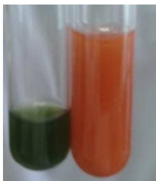
Figura 14. Prueba Benedict (azúcares reductores). Tubos de izquierda a derecha: extracto de papalo + reactivo de Benedict (prueba positiva), soluci3n de glucosa + reactivo de Benedict (testigo).
