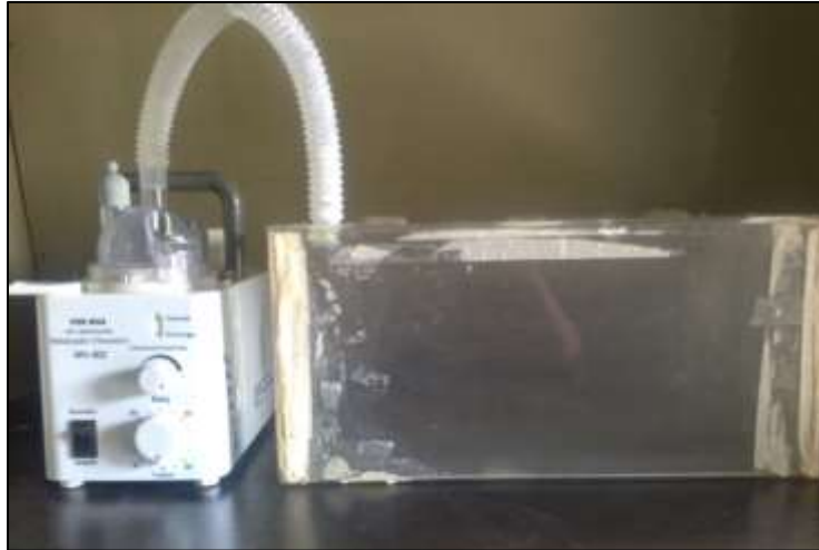
Figura 8. Nebulizador y caja de acrílico. Una vez introducidos los ratones y la solución a inhalar, se sellaba la caja totalmente.
