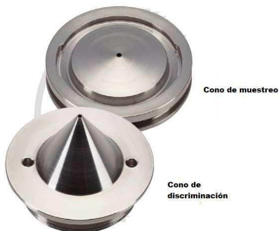
Figura 3-8. Conos de muestreo y de discriminación. (Perkin Elmer Catalogue, 2010)
