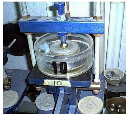
Prueba de Consolidación
