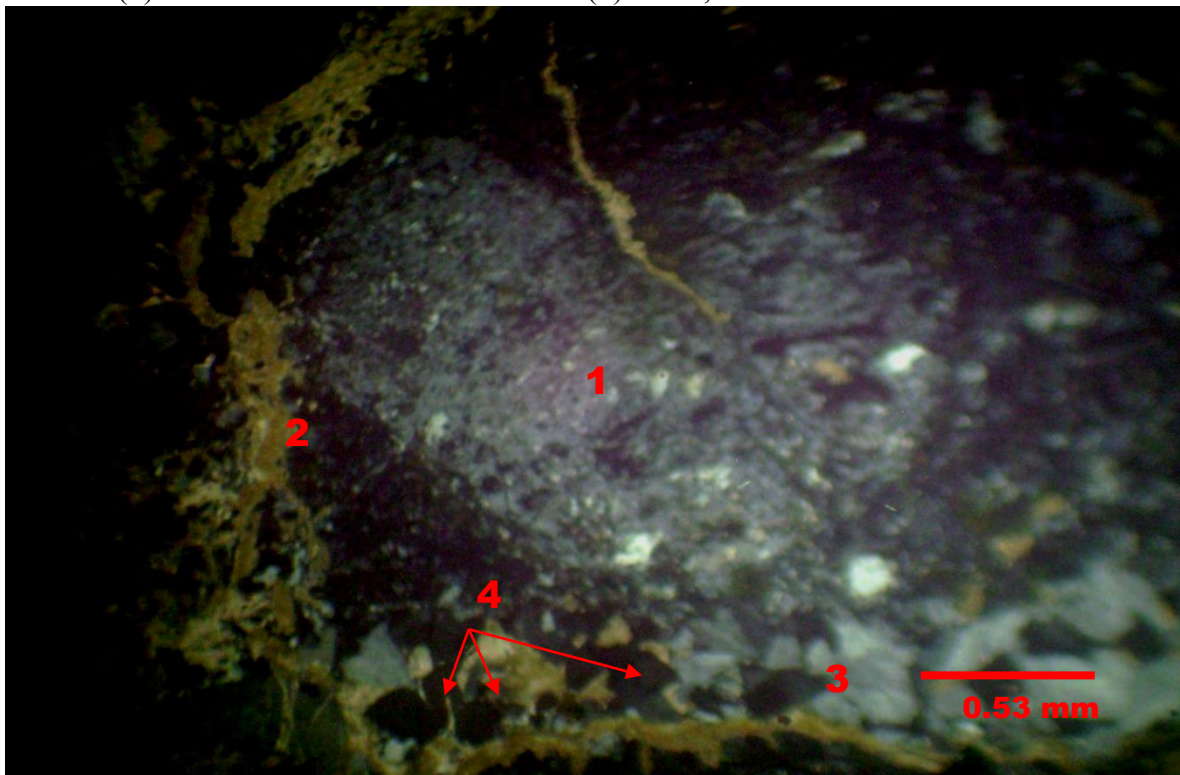
Fotomicrografía 3. Muestra C-3a.- Se observan feldspatos introducidos, quizás adularia (1), así como una vetilla rellena de carbonatos (2), cuarzo (3) y metálicos asociados (4). 40 X, L.P.
