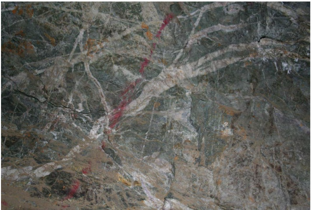
Foto 4.8.- Vetas de una etapa posterior cortan fragmentos de brecha formados en un evento previo en el que también hubo introducción de metálicos, y sílice en forma de vetillas y como reemplazamiento en los bordes. Esas vetillas, aquí, atraviesan fragmentos y bordes reemplazados.
