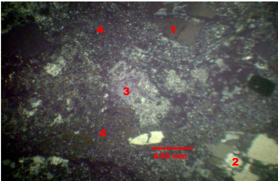
Fotomicrografía 4. Muestra C-36a. - Otra vista de la muestra, en donde se observan cristales de cuarzo (1), feldespatos rotos (2), una probable plagioclasa muy alterada (3) y matriz de microcristalina a felsofírica (4). 40 X, L.P.
