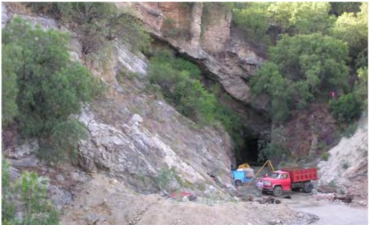
Foto 3.2.- En este lugar la Veta Madre alcanza ancho cercano a los 90 m; corresponde a la mina San Vicente, en la superficie correspondiente al “lavo dce Rayas” en la profundidad.
