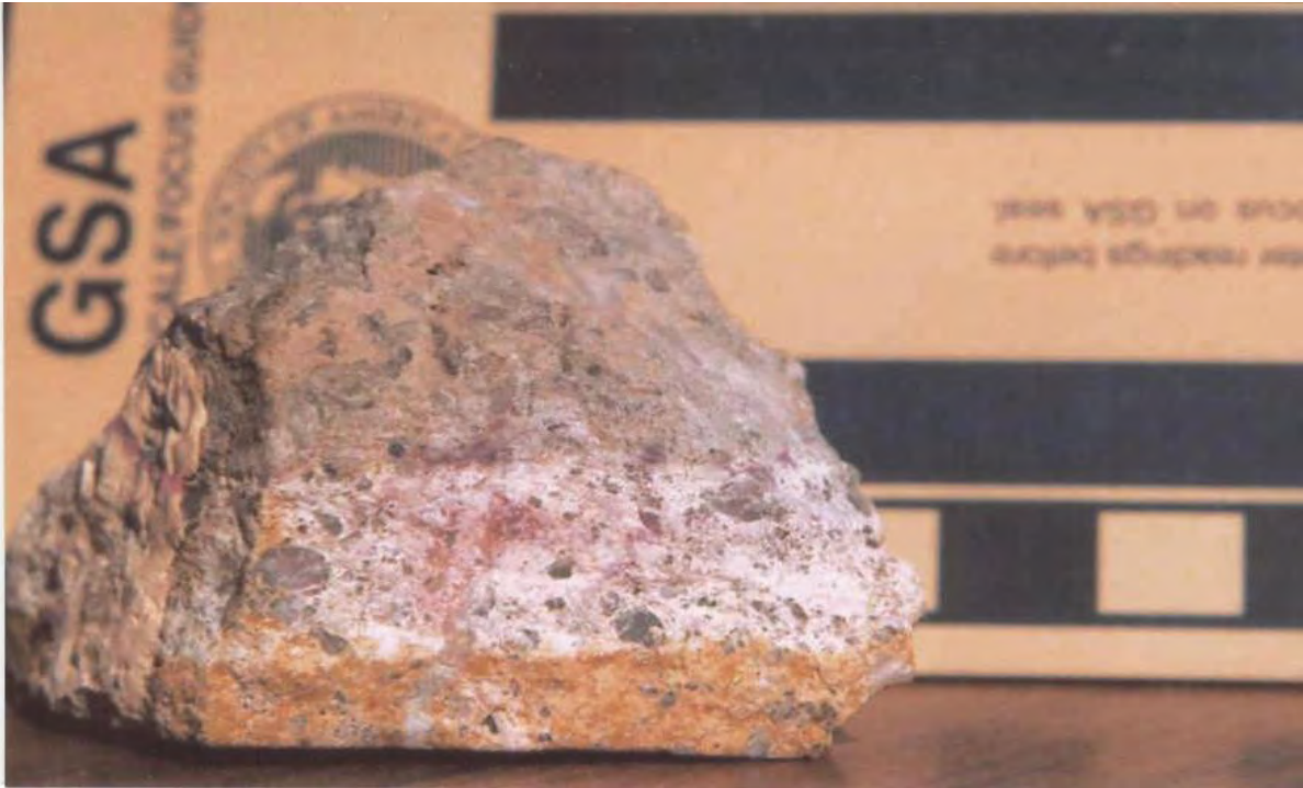
Foto 4.3.- Es la muestra C-36, del otro tipo de los —intrusivos de Rayas”, en realidad una riolita sub-volcánica, de textura seriada. Se aprecian fenocristales de 3 a 7 mm, como —ojos de cuarzo”. También la alteración potásica es notable, con el teñido que se le hizo.
