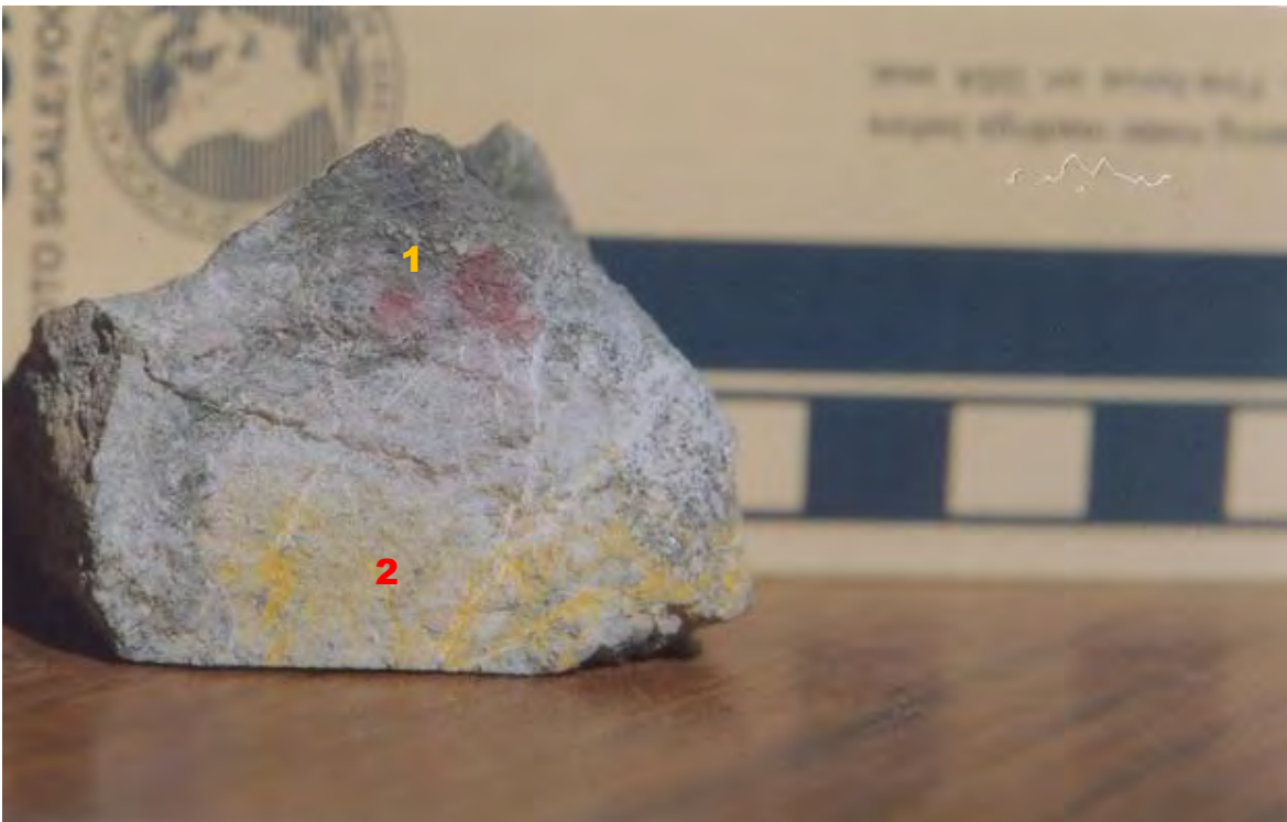
Foto 4.4.- Brecha mostrando un fragmento de andesita (1) y otro de riolita (2) ambos intensamente alterados, dentro de una masa de material triturado (protomilonita) con alteraciones argílica, y también potásica según la reacción con cobaltinitrito de sodio y rodizonato.
