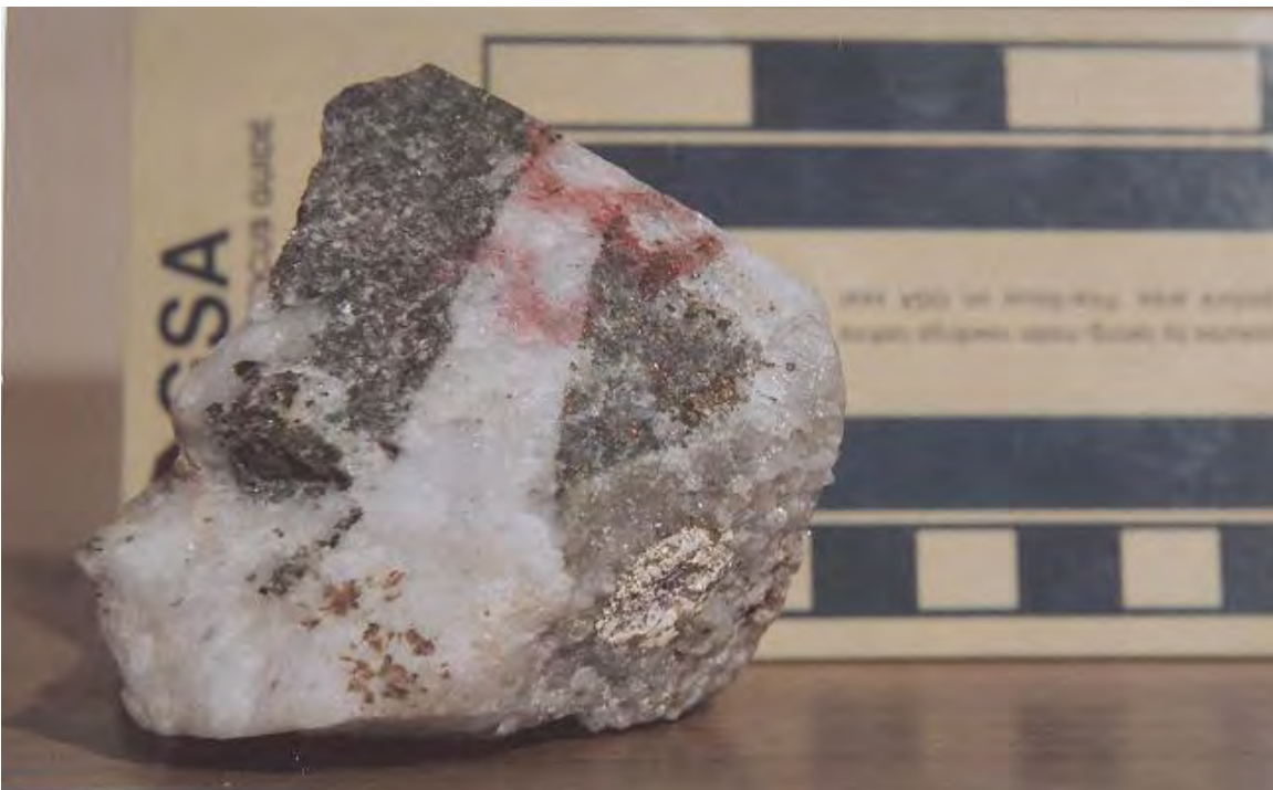
Foto 4.2.- Corresponde a la muestra C-17; un fragmento de brecha del clavo de Rayas, de roca diorítico-andesítica, evidenciando la secuencia de eventos sufridos: 1) débil mineralización, 2) brechamiento, 3) cementación con cuarzo, 4) nuevo brechamiento 5) re-cementación. Es un ejemplar de los considerados como —intrusivos de Rayas”.
