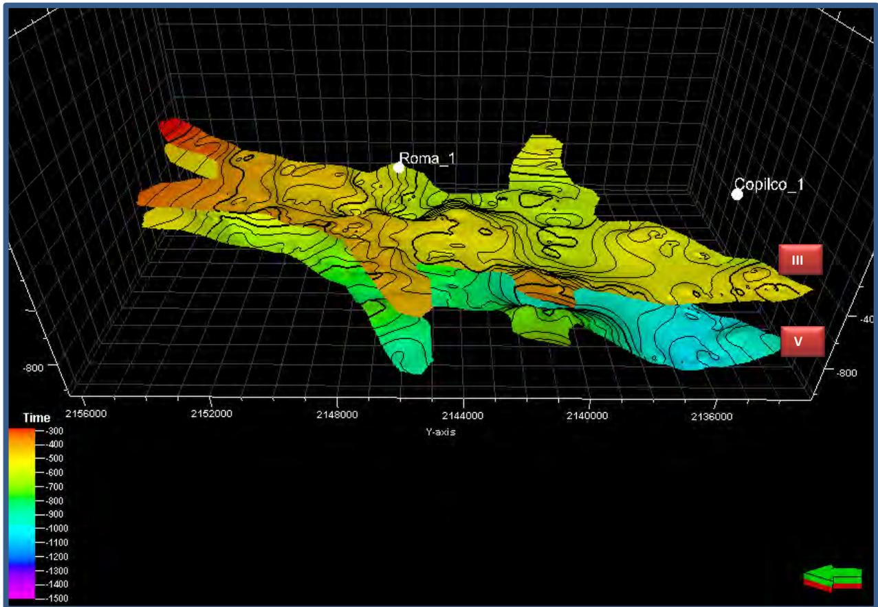
Figura 4.22. Vista Oeste de las superficies II y V donde se muestra la discontinuidad del relieve entre dos discontinuidades.
