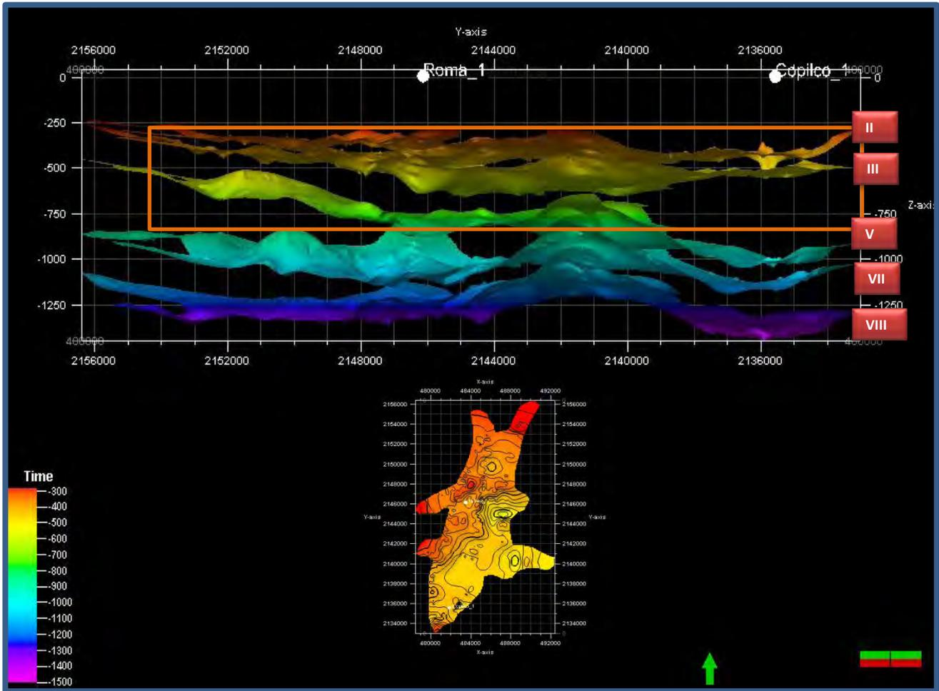
Figura 4.25. Vista Oeste de las superficies II y II donde se aprecia que ya que ya no sigue el relieve alto, ya que tiende hacerse más horizontal, aunque sigue conservando un contraste de relieve positivo que corresponde con el Alto de Mixcoac.
