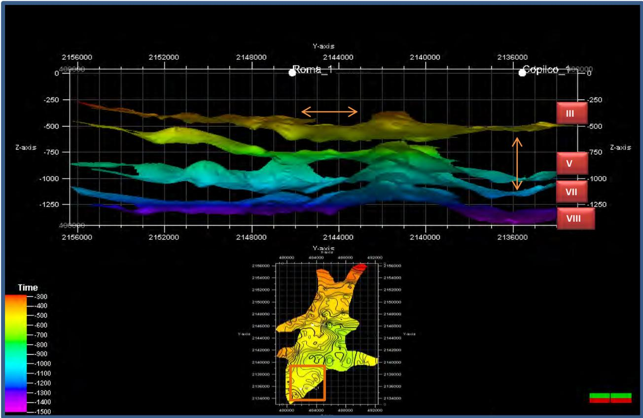
Figura 4.23. En la imagen de arriba se muestra las superficies III, V, VII y VIII. La superficie III tiende hacerse más horizontal. Abajo esta su correspondiente mapa estructural donde se visualizan los altos y depresiones predominantes.
