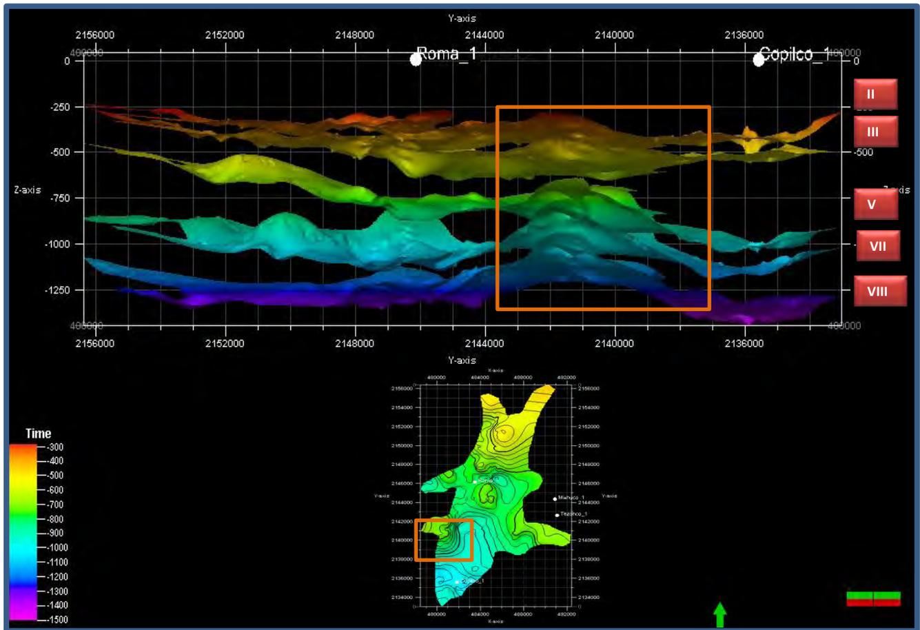
Figura 4.21. Mapa estructural en tiempo para el alto de Mixcoac. El recuadro anaranjado encierra la zona donde se puede visualizar la estructura.
