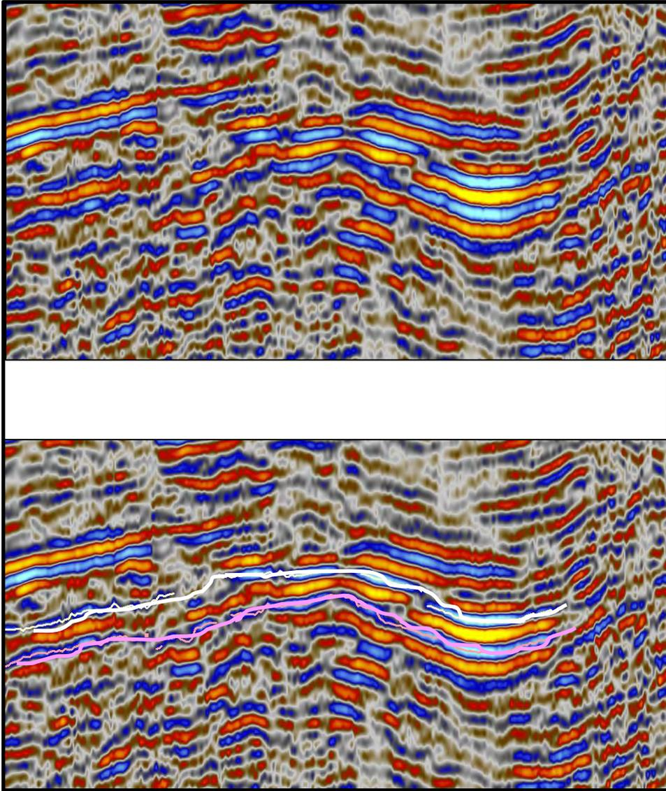
Figura 2.7. Sección sísmica del área de estudio (Zona Poniente del Valle de México) sin interpretar (arriba) y su respectivo marcado de dos horizontes (abajo).
