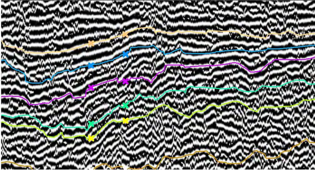
Figura 2.9. Sección sísmica del área de estudio (zona poniente del valle de México), donde se aplica el atributo coseno de fase y se marcan algunos horizontes base.
