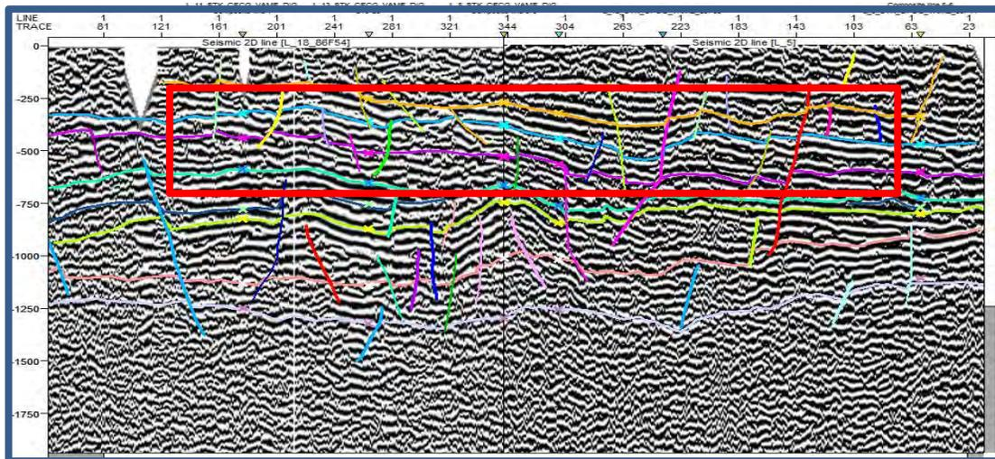
Figura 4.24. Línea compuesta 18-5. Que muestra dentro del recuadro rojo el subparalelismo entre los horizontes I, II y III marcados con anaranjado, azul y morado respectivamente. Se puede ver que también ya no se presentan acuñamientos.
