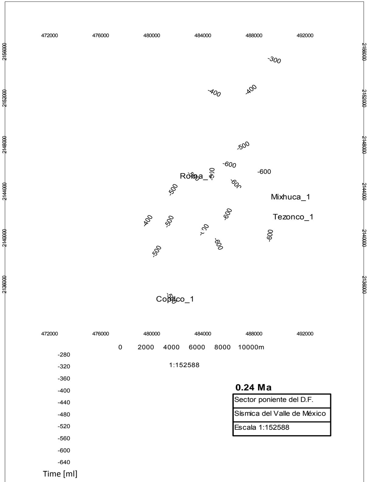
Figura 4.10. Mapa estructural en tiempo de la superficie VIII, donde se indica hacia donde caen los bloques de techo de las fallas normales interpretadas. En líneas punteadas se muestra la posible correlación de entre estas, con orientación preferencial E-W y echado de 80°.
