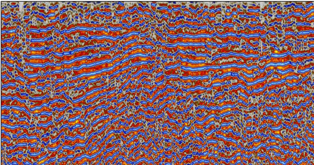
Figura 2.8. Sección sísmica sin interpretar del área de estudio (zona poniente del valle de México), en donde se recomienda aplicar el atributo coseno de fase para visualizar mejor las estructuras.
