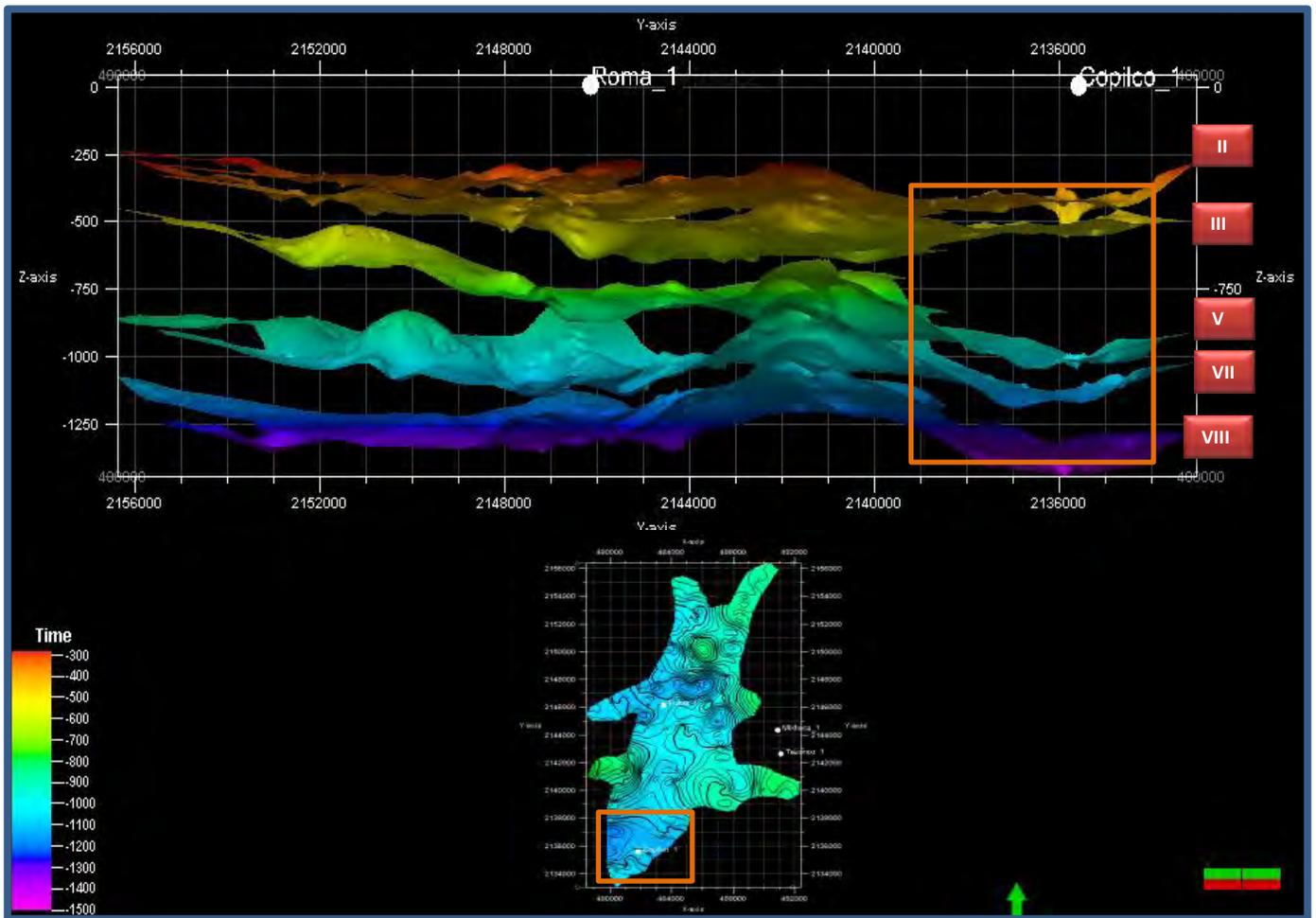
Figura 4.18. Arriba se muestra dentro del recuadro anaranjado, la evidente depresión en la zona de Copilco. Debajo, el mapa que representa el horizonte V.
