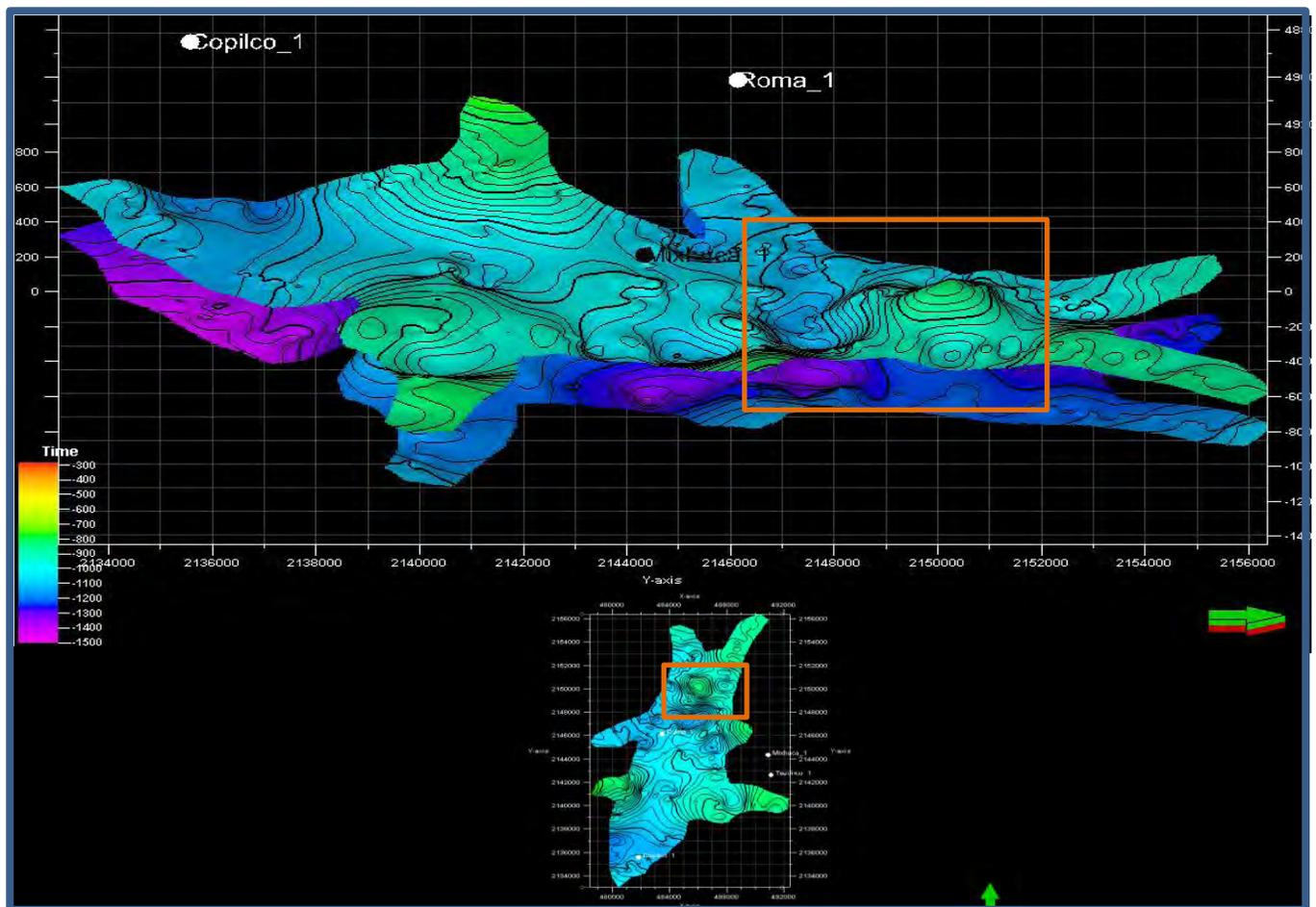
Figura 4.19. Imagen en 3D que muestra el relieve generado con los horizontes VII y VIII en donde, el recuadro anaranjado, muestran la depresión o bajo de Tepeyac y el alto Tenochtitlan.
