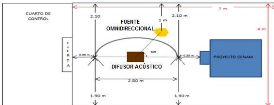
Figura 17.- Montaje de medición dentro de la cámara anecoica
