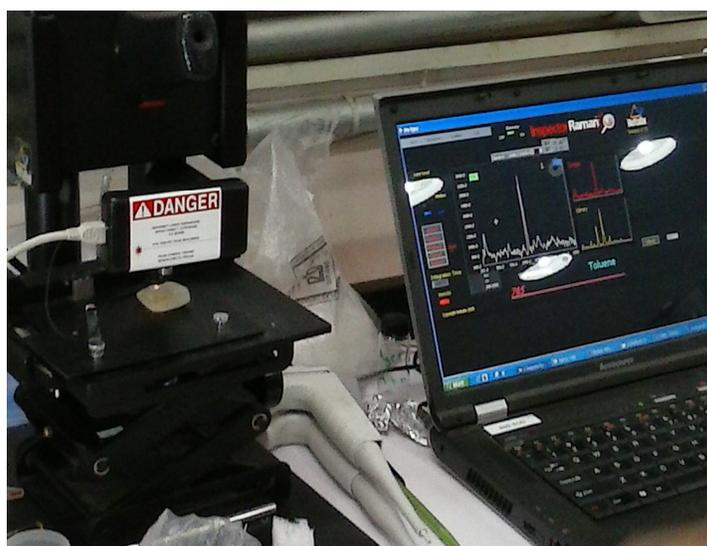
Figura 35. Espectrómetro Delta Un para Raman.
